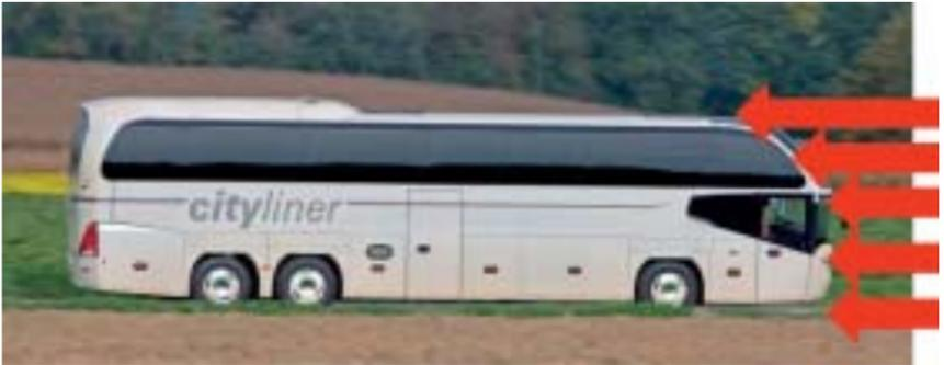
Der Luftwiderstand ist auch abhängig von der Windrichtung und der Windstärke. Die Gestaltung der Flächen am Fahrzeug hat großen Einfluss auf dessen Wirkung. Dieser Widerstandswert kann sowohl positiv (Rückenwind) als auch negativ (Gegenwind) in Erscheinung treten.
