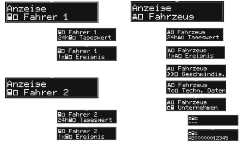
Abb. 4-14: Über das Display können eine Reihe von Informationen aus dem erfassten Datenbestand der Fahrerkarte und der Fahrzeugeinheit aufgerufen werden.
